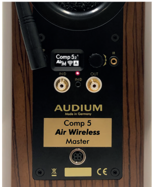
Air 无线版主音箱的背面板： 同轴和光纤数字输入端口，同轴输出端口（用于有线连接），液晶屏和旋钮，wi-fi天线
